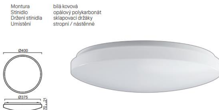
Obr. 1 Svítidlo A- LED svítidlo přisazené, stropní, kovová montura, opálový polykarbonátový kryt (d 400) 3750 lm, 24W 3000 K, IP 54
